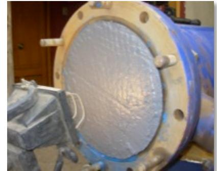
Recuperación de espejos desgastados y con corrosión, producto de años de uso continuo. Para recuperar los espesores perdidos se utilizó **CeramAlloy CP+AC** y para el acabado resistente y duradero el **CeramAlloy CL+AC** en los espejos y tapas del sistema.
