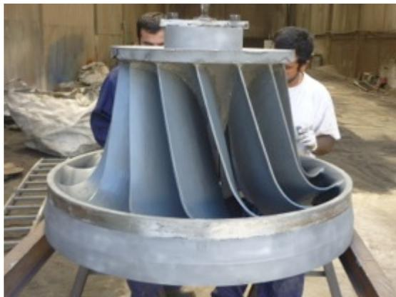
Luego de limpiar y granallar el equipo, se aplicó **METALCLAD® CeramAlloy CP+AC** con el fin de recuperar espesores y posteriormente **FLEXICLAD® Duratough DL** con el fin de proteger del efecto cavitacional.
