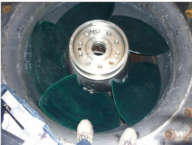
Con mucha precisión se aplicó **METALCLAD® CeramAlloy CP+AC** con una espátula por todo el perímetro con el fin de recuperar la superficie en el equipo y así evitar pérdida de eficiencia de la turbina. Finalmente se procedió el montaje final de la turbina totalmente recuperada y con la garantía de extensión de su vida útil por muchos años más. Un ahorro importante para el cliente.
