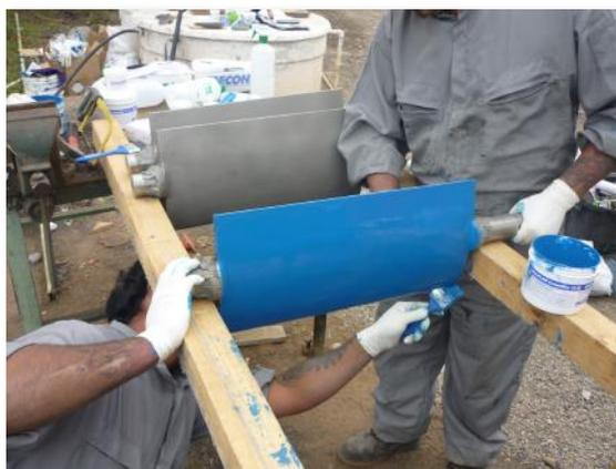
*Se aplicó **METALCLAD® CeramAlloy CP+AC** con el fin de recuperar espesores y formas en el equipo. Finalmente se aplicó **METALCLAD® CeramAlloy CL+AC** como terminación final contra la abrasión.*
