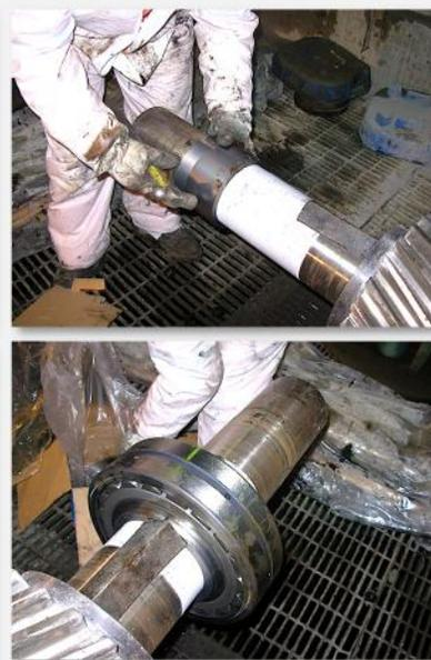
*Después de los tiempos adecuados de cura, los ejes fueron montados nuevamente en el molino. **DurAlloy** entregó la solución precisa al problema de tolerancia y asentamiento del manguito, además de proveer un considerable aumento en la vida útil de los ejes.*
