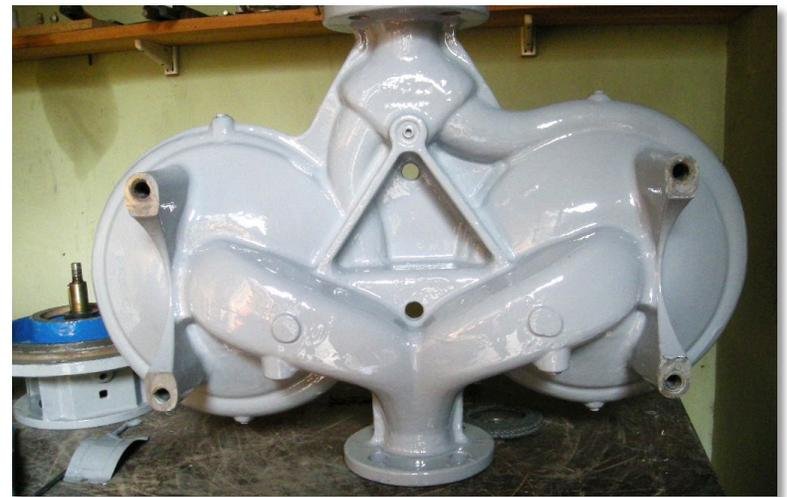
*La corrosión externa de la carcasa es debido a la humedad y temperatura del ambiente. Se utilizó el **CHEMCLAD SC**, que protege la carcasa del medio y que proporciona un acabado resistente.*
