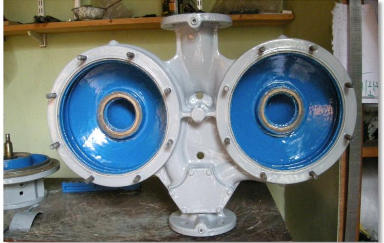
*Bomba con problema grave de corrosión por incrustaciones, debido a la dureza del agua. Se utilizó **CeramAlloy CL+AC** que impide que se generen incrustaciones, proporcionando un acabado liso y resistente.*
