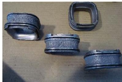
Estos moldes compuestos por diferentes piezas presentan un deterioro significativo por la exposición constante al agua que circula en el interior, ésta actúa como reguladora de temperatura mientras se moldean los envases.
