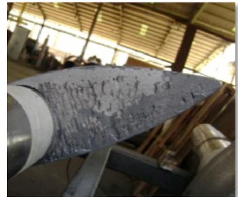
La superficie de los alabes directriz es preparada por medio de granallado a un perfil de rugosidad de 75 micras, permitiendo una situación óptima de anclaje para el revestimiento a aplicar. El esquema de aplicación de productos que fue realizado consistió en **CeramAlloy CL+AC**, en colores gris y azul respectivamente.
