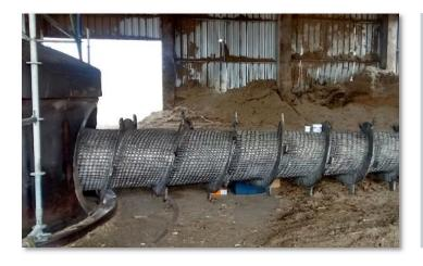
En esta importante fábrica de tableros de fibra de madera, la acción abrasiva de chips de madera residual utilizados como biocombustible, provocaba serios daños al tornillo sin fin que traslada este material para alimentar las calderas.
