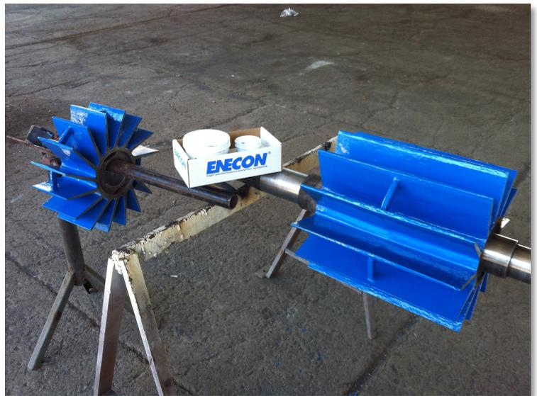
El impulsor presentaba un avanzado estado de corrosión y presencia de "pitting" en los bordes de los álabes. La solución dada por **ENECON** fue volver a la geometría original usando **CeramAlloy CP+AC** en pasta y finalmente aplicar **CeramAlloy CL+AC** gris como primera capa y **CeramAlloy CL+AC** azul como capa final, extendiendo significativamente la vida útil del impulsor.
