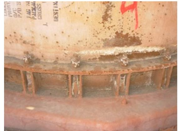
En una importante Empresa Minera la unidad que se encarga de limpiar los gases que emanan de los procesos productivos, se encontraba con alto grado de deterioro. El equipo llamado Quench Ventury fue sometido a un proceso de limpieza mediante granallado para posteriormente aplicar **CHEMCLAD SC** para dar protección a este equipo por muchos años más.
