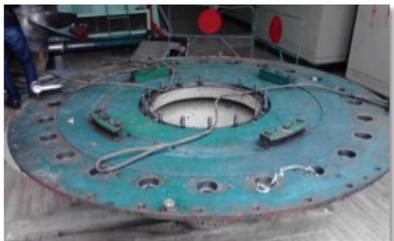
Preparación y granallado de la base con el fin de limpiar toda estructura. Se aplicó **CeramAlloy CBX** como protección contra la abrasión severa de esta parte del equipo.
