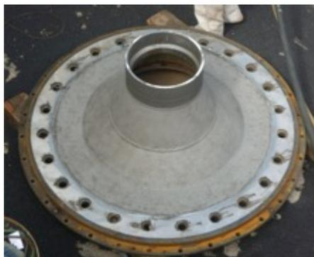
Luego, por solicitud del cliente, se aplicó **METALCLAD® CeramAlloy CP+AC** con el fin de suavizar el aspecto rugoso del **CeramAlloy CBX**. Finalmente se aplicó **FLEXICLAD® Duratough DL** para proteger una zona específica contra la cavitación.
