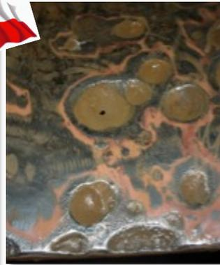
Extremo desgaste por corrosión y erosión en la estructura metálica de la escotilla, presentando incluso señales evidentes de perforación en el metal.
