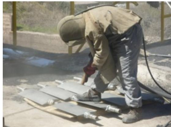
*Preparación y granallado de los álabes con el fin de dar mayor anclaje y dejar en máxima evidencia piezas con exceso de desgaste. El principal desafío es recuperar la geometría de las piezas.*
