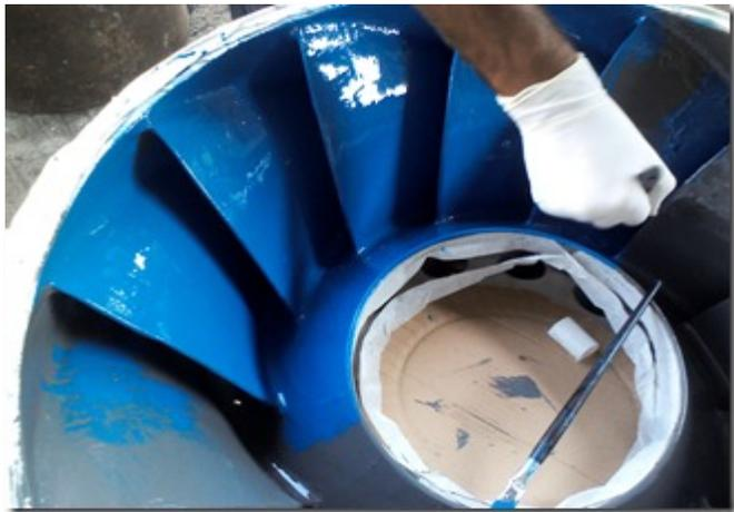
Esquema aplicado consiste en dos capas de **METALCLAD CeramAlloy CL+AC**, en colores gris y azul respectivamente. Como resultado se obtiene rodete protegido contra el desgaste y la erosión permitiendo mejorar la eficiencia y a la vez prolongar considerablemente los plazos entre mantenciones y sus costos asociados.
