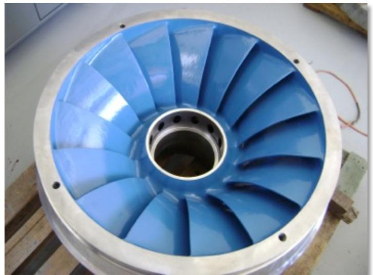
La superficie de rodete de turbina Francis es preparada por medio de granallado a un perfil de rugosidad de 75 micras, permitiendo una situación óptima de anclaje para el revestimiento a aplicar.
